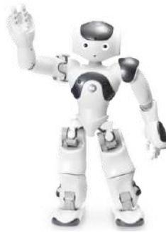
**Abbildung 1.2** Der in der RoboCup SPL verwendete Roboter *NAO V6*.
