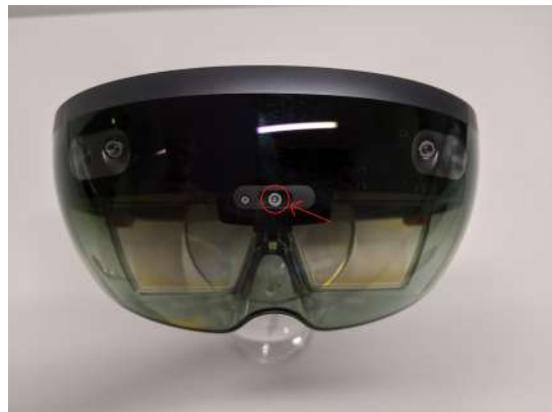
Abbildung 2.4: Frontansicht der HoloLens mit hervorgehobener Weltkamera.
