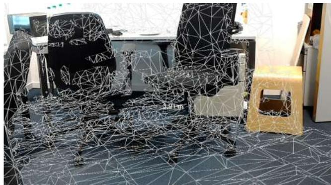
Abbildung 2.3: Visualisierung des Spatial Mappings der HoloLens.
