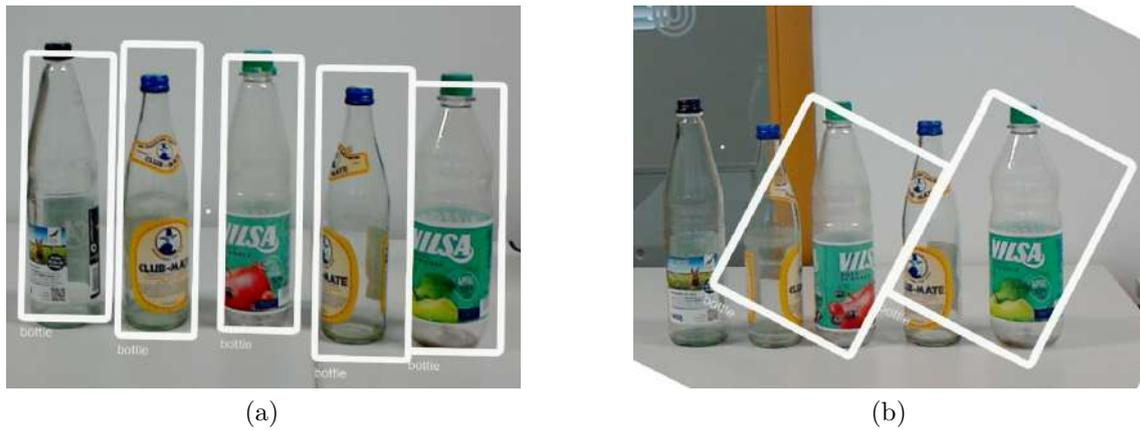
Abbildung 5.5: Vergleich der Objekterkennung mit YOLOv3 beim Wanken des Kopfes. a) Nahezu kein Wanken, alle Flaschen werden korrekt erkannt. b) Wanken um ca.  $27^\circ$ . Es werden nur noch 2 Flaschen erkannt. Das Bild wurde für eine bessere Vergleichbarkeit manuell gedreht.
