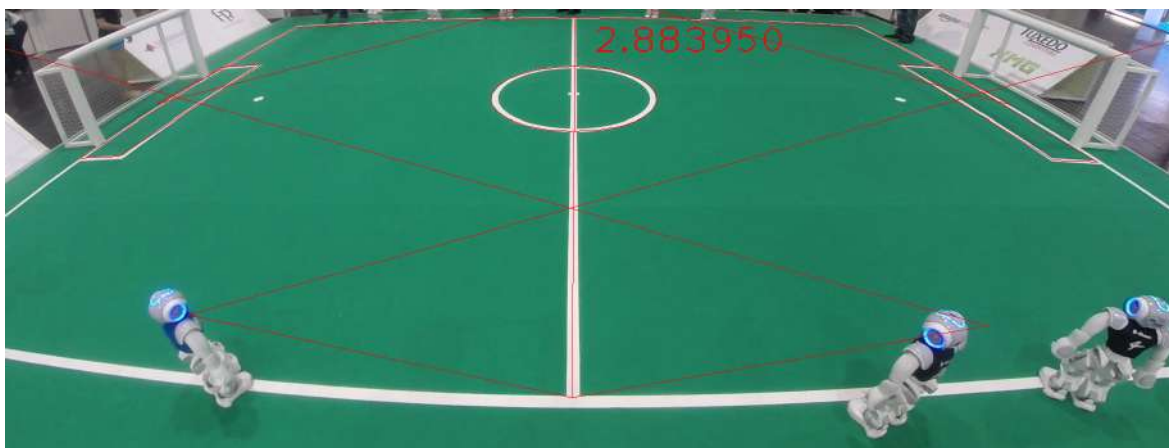
Abbildung 7.11 Der Projektionstest einer unvorteilhaften Kalibrierung, bei dem die erwarteten Feldlinien mit dem von OpenCV ermittelten Projektionsfehler in das Bild gezeichnet wird.
