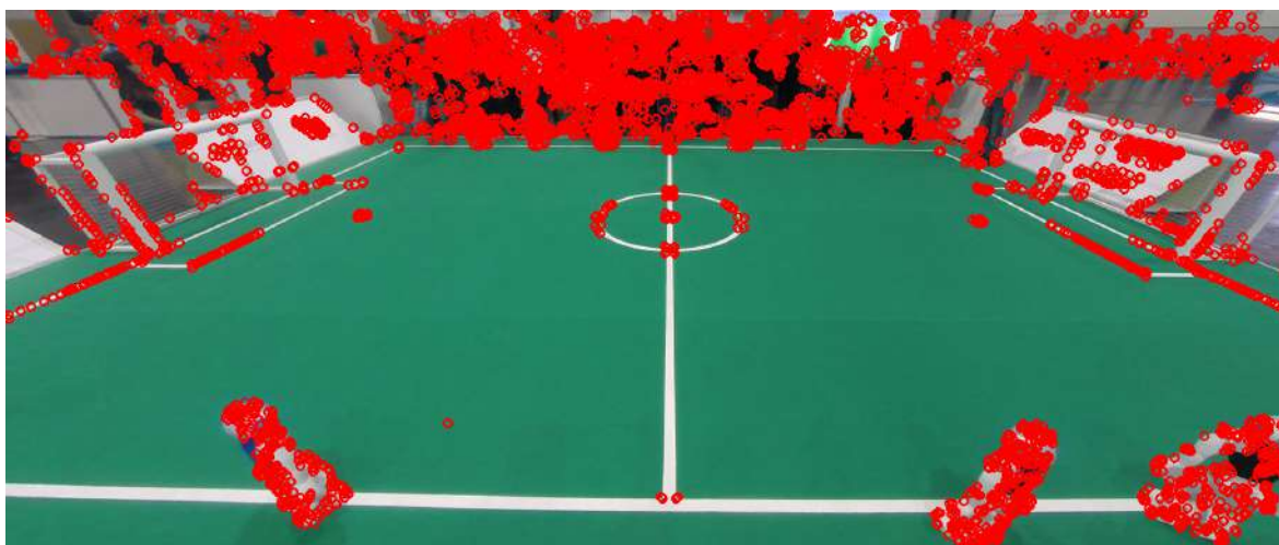
Abbildung 6.1 Anwendung von FAST auf das gesamte Bild.
