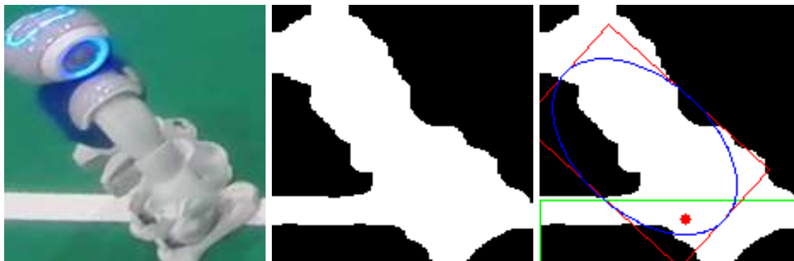
Abbildung 8.9 Bildreihe, die für das Tracking eines Roboters erstellt wird. In (a) der Ausschnitt des echten Roboters, in dem ein Roboter verifiziert werden soll. (b) stellt das Nicht-Grün-Bild des Ausschnittes dar. (c) ist die Debug-Sicht der Fußpunktdetektion.
