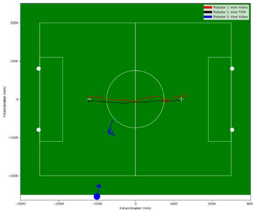
Abbildung 10.30 Visualisierung der manuell verbesserten Trajektorien der Roboter im Vergleich zu der Lokalisierung des laufenden Roboters aus dem ersten Versuch.
