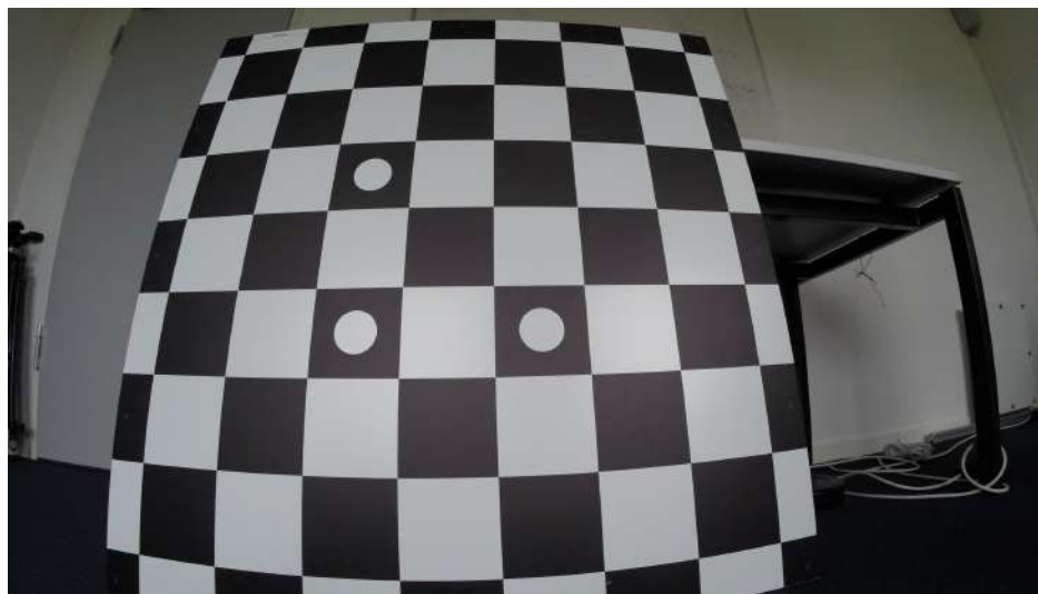
Abbildung 7.6 Ein Beispielbild aus den Bilddatensätzen, die für die intrinsische Kamerakalibrierung verwendet wurden.
