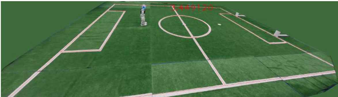
Abbildung 10.10 Der Aufbau des Groundtruth-Experiments. Der Roboter soll vom linken Strafstoßpunkt zum rechten laufen.
