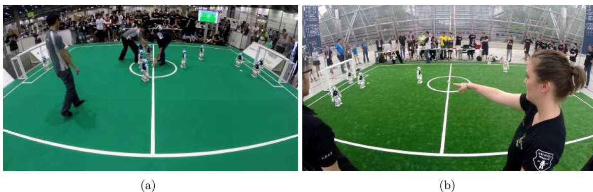
Abbildung 8.12 Beispiele möglicher Verdeckungen, die nicht durch Roboter entstehen. Wobei (a) durch Synchronisation der Netzwerk-Nachrichten unterscheidbar wäre im Gegensatz zu (b).
