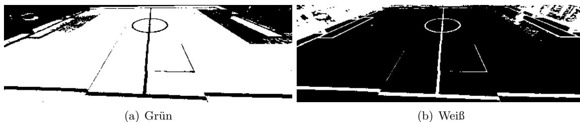
Abbildung 10.2 Das Resultat des speziell parametrisierten Gaussian Mixture Model auf dem Testspielvideo.
