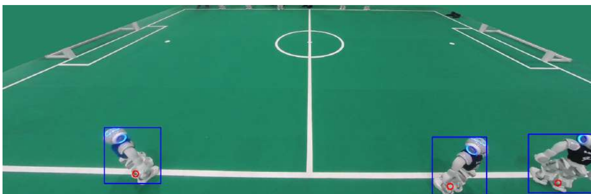
Abbildung 8.8 Die Ergebnisse der Roboterdetektion. In Blau sind die ROIs der detektierten Roboter und in Rot die Fußpunkte gezeichnet.
