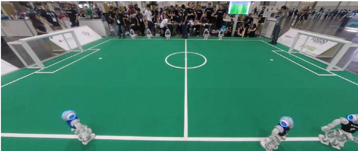
Abbildung 7.8 Das Ergebnis der Entzerrung eines Bildes der Auflösung 1920 \times 1080 .
