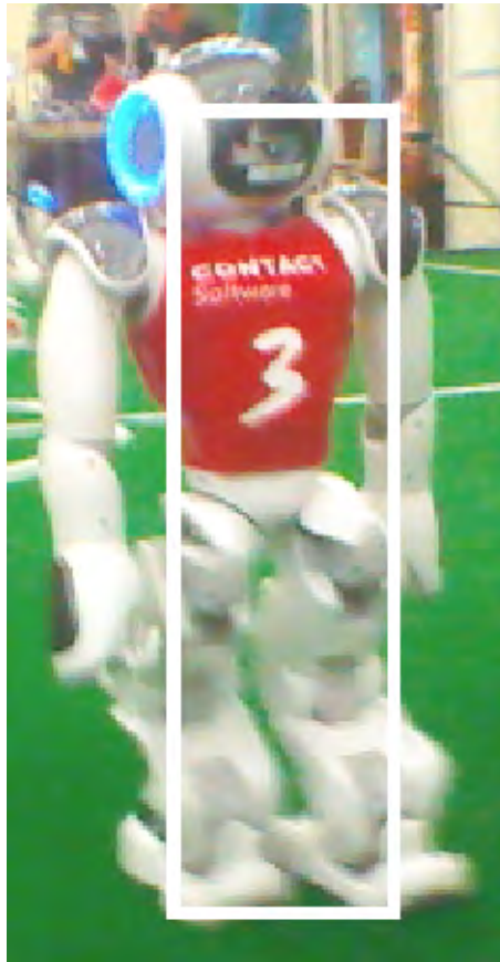
Abbildung 2.1: Die Abbildung zeigt einen NAO-Roboter mit einer Bounding-Box (weiß), welche aus der aktuellen Implementierung stammt. Die große Schwäche des genutzten Ansatzes ist, dass nur Fußpunkte genutzt werden, um die Größe des Roboters im Bild zu ermitteln. Die Arme werden nicht berücksichtigt, was zu ungenauen Bounding-Boxes führt.
