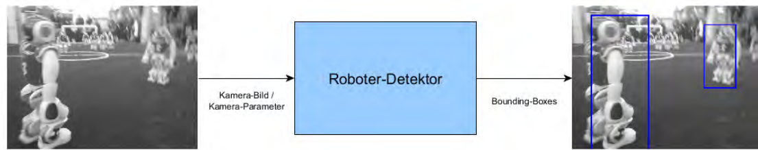
Abbildung 5.1: Beispiel für Ein- und Ausgaben des entwickelten Detektors.
