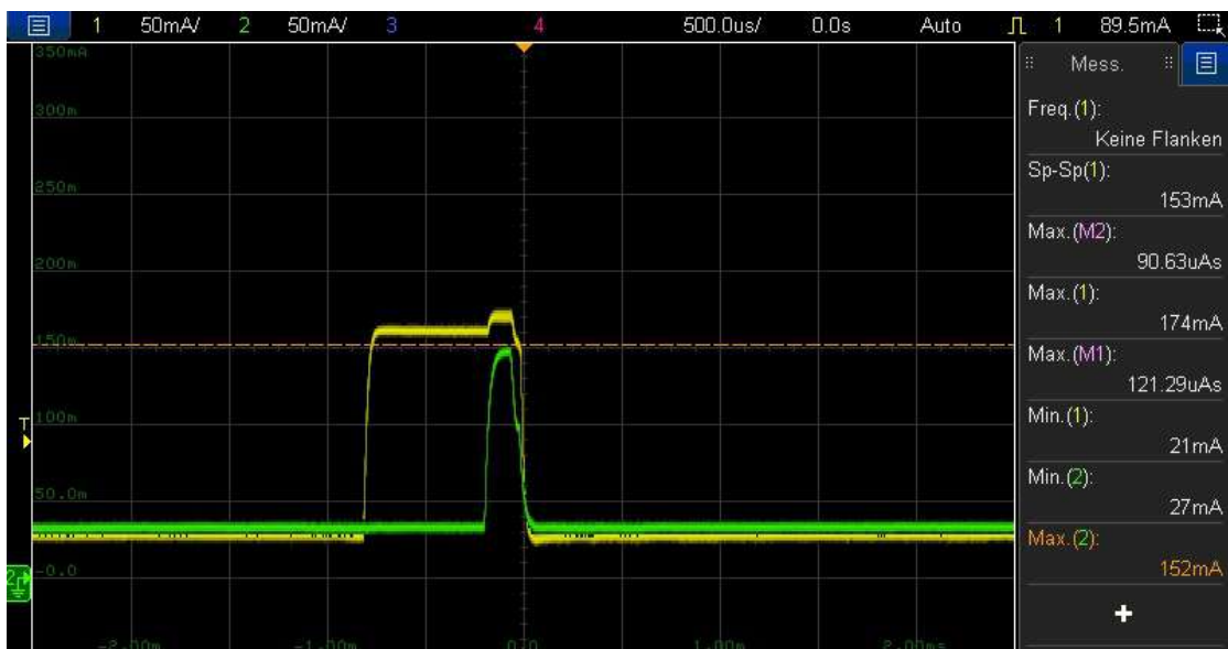
ABBILDUNG 5.4: Energieverbrauch der Transceiver eines Knotens (gelb) und des Coordinators (grün) während eines Beacon Slots
