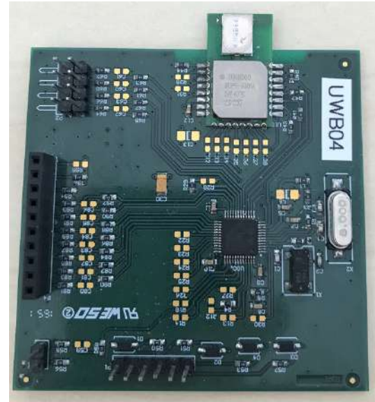
(b) Die eingesetzte Zielhardware. Integriert auf dem Board sind neben dem Mikrocontroller und dem DW1000 auch Stromversorgung Adapter für die Nutzung von SD Karten
