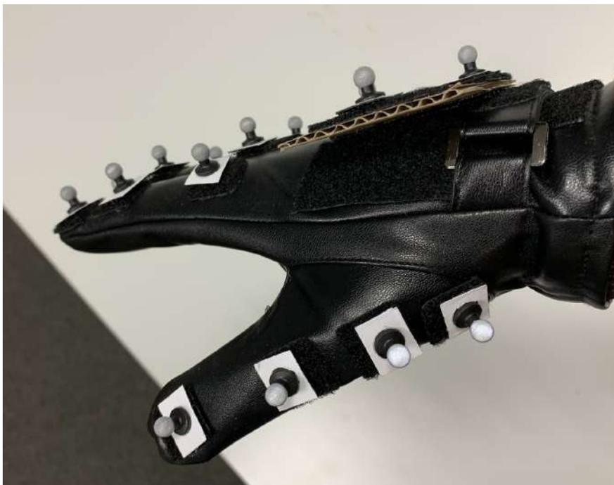
Abbildung 3.18.: Der konstruierte Handschuh (Ansicht von der Daumenseite).
