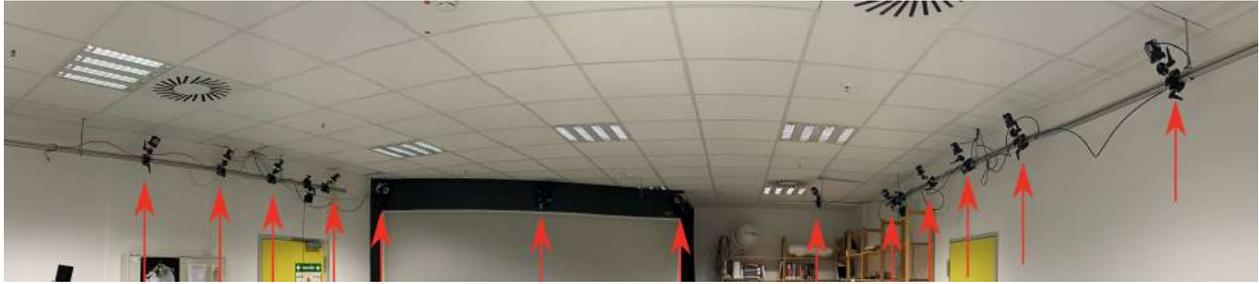
Abbildung 3.19.: Das Labor mit dem aufgebauten OptiTrack-System. Die Kameras wurden mit roten Pfeilen markiert.
