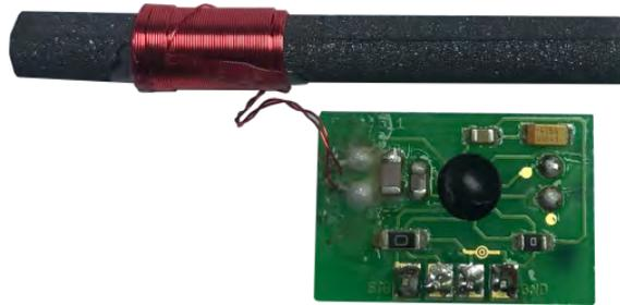
Abbildung 6.5: DCF77-Modul mit 77,5 kHz Ferritstabantenne
