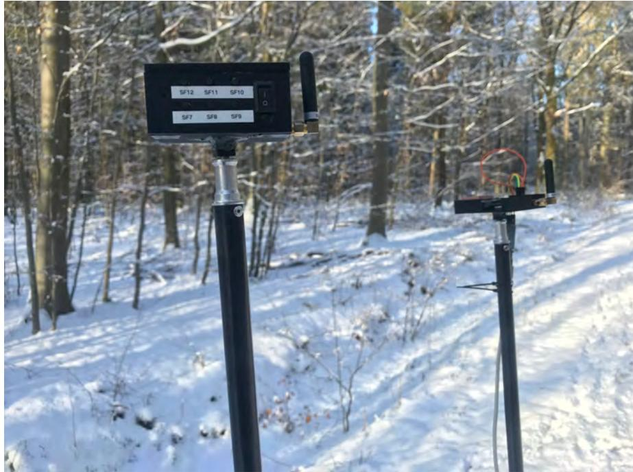
Abbildung 3.3: Sender (links) und Empfänger (rechts) befestigt auf einem Stativ in einem Wald in der Nähe von Steinhorst (Schleswig-Holstein, Deutschland)
