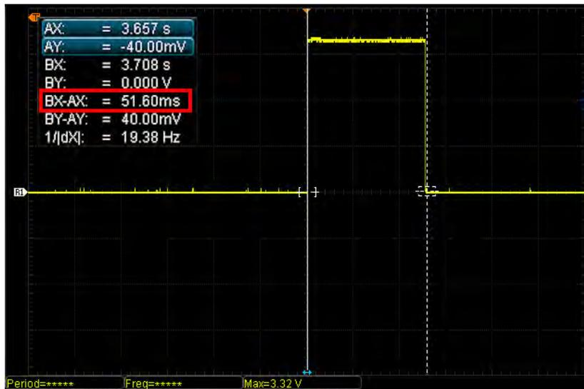
Abbildung 6.2: Benötigte Zeit für das Auslesen von der Temperatur und der relativen Luftfeuchtigkeit mit Hilfe eines BME280
