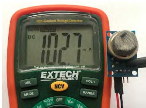
Abbildung 6.3: Strombedarf eines MQ-135 Gassensors (in Milliampere)
