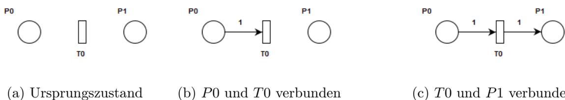
Abb. 4.4.: Aufbau von Verbindungen mit der `addArc()` Funktion
