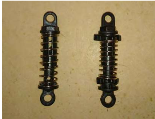
Abbildung A.5.: Stoßdämpfer, links original und rechts gekürzt
